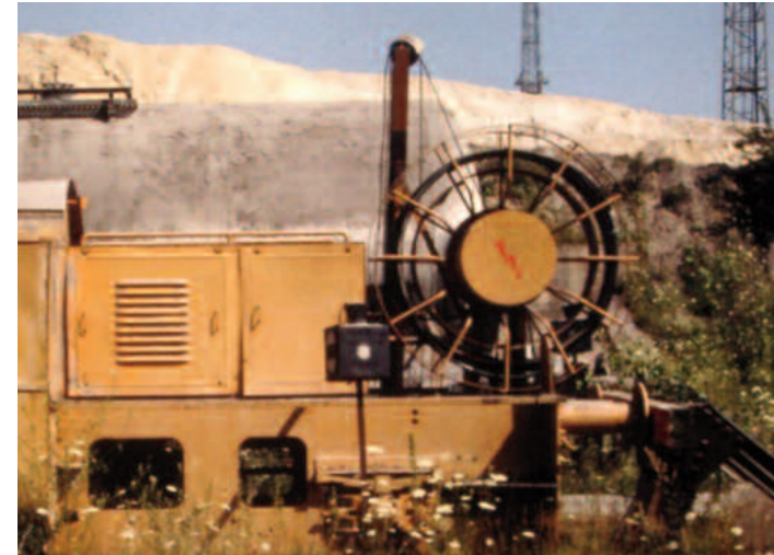
Detailaufnahme der Kabelaufwicklung der LKM 249910
