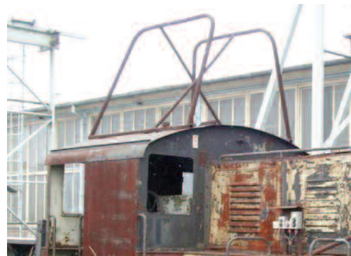
Detail der Stromabnehmer der LKM 249836
